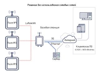
Модем LoRAWAN соединен беспроводной связью с базовой станцией LoRAWAN, базовая станция посредством широкополосного канала Ethernet (или 3G), соединяется с сервером LantanSoft, который опрашивает через организованный канал связи газоанализаторы и метеостанцию.
