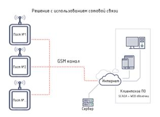
Модем сотовой связи соединяется по каналу GSM с сервером LantanSoft, который опрашивает через организованный канал связи газоанализаторы и метеостанцию.
